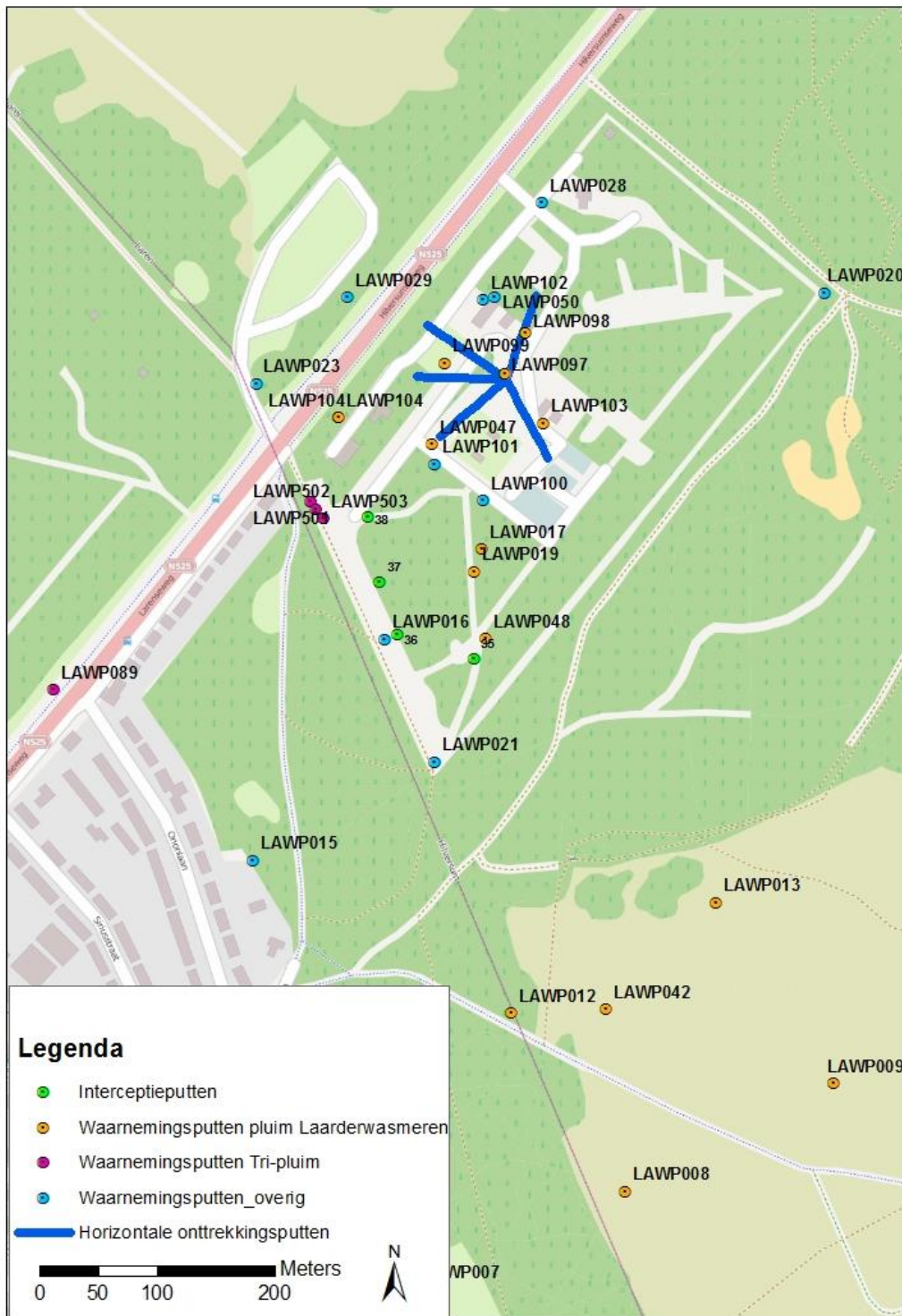
Figuur 4: Detail van het waterwingebied van de drinkwaterwinning Laren met onttrekkingsputten, interceptieputten en waarnemingsputten.
